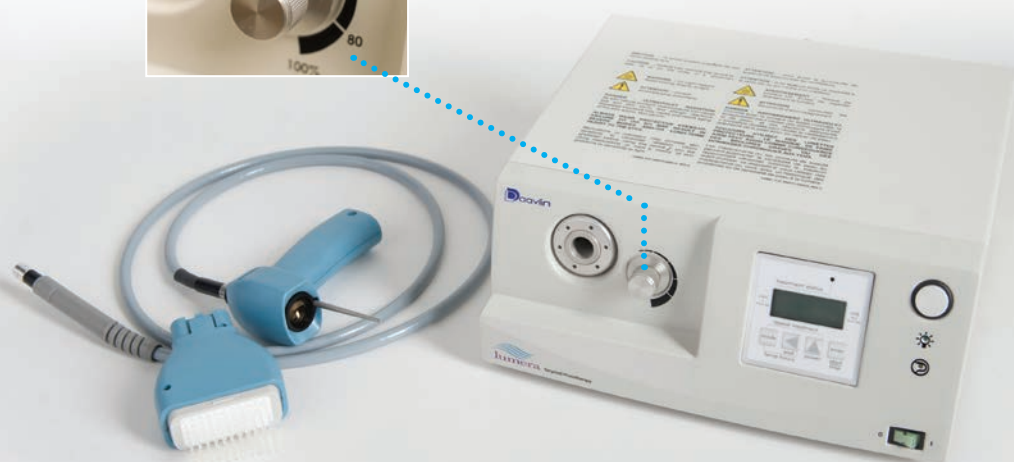
Contrôle dosimétrique de l'irradiance et minuterie précise.
